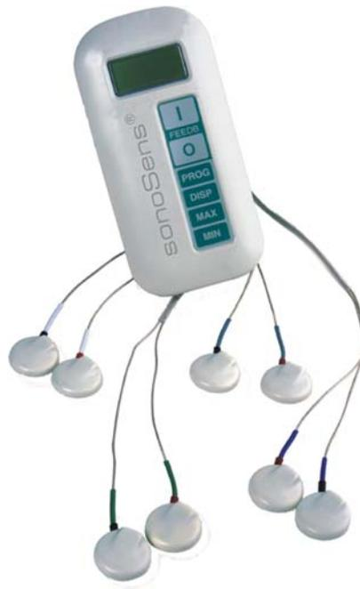
Abb. 1 ▲ Das Messgerät: *sonoSens*® mit einer Zentraleinheit (m=120 g, inklusive Batterien). Die Messfrequenz beträgt zwischen 1 und 50 Hz. Es können Messungen sowohl online als auch offline durchgeführt werden. Die beiden Sensorenpaare bestehen jeweils aus einem Sender und einem Empfänger und werden mit handelsüblichen EKG-Kleberingen auf der Haut befestigt [6]
